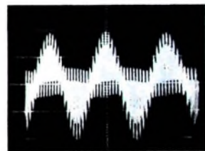
Bild 52. Multiplexsignal wie im Bild 51, jedoch bei 100 \mu V Eingangsspannung (Antennensignal)
