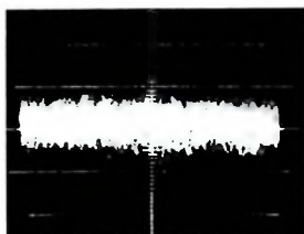
Bild 49. Ausgangssignal des Empfängers während einer Modulationspause; der Sender strahlt keinen Piloton ab
